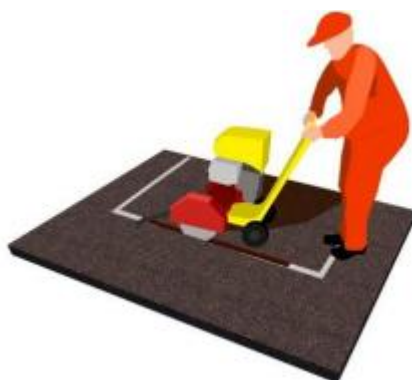
Figura 2– Corte e remoção do revestimento asfáltico.
