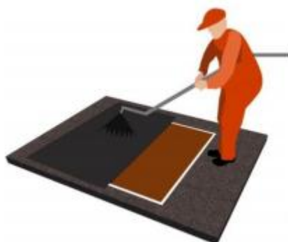
Figura 3 – Execução da pintura de ligação.
